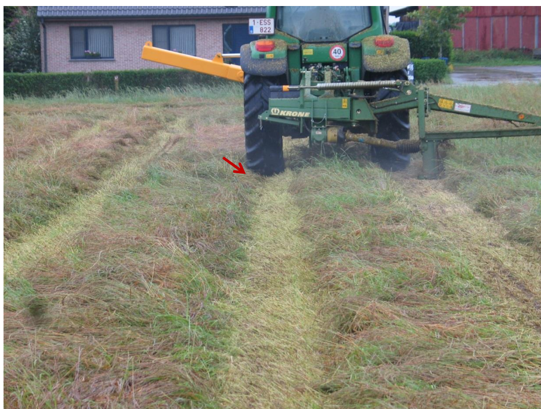
Foto 4: niet aangepaste spoor- en/of bandbreedte bij zijmaaier ZW2
